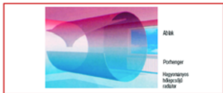
1. ábra. Hagyományos hőfoklépcsős (pl. 90/70 °C-os) radiátoros fűtésnél (és természetesen a gázkonvektoros fűtésnél) kialakul az allergiás megbetegedést okozó ún. porhenger. (Forrás: Wikinger cég, Harreither cég)
